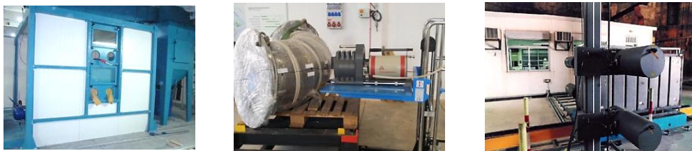
図5 乾式除染装置、Ge 半導体分析装置、クリアランスモニター
